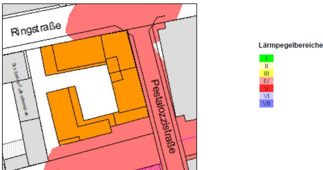
Abb 2: Lärmpegelbereiche für Lüftungseinrichtungen (rot: Pegelwerte nachts > 50 dB(A)), Quelle: Büro Heine+Jud
