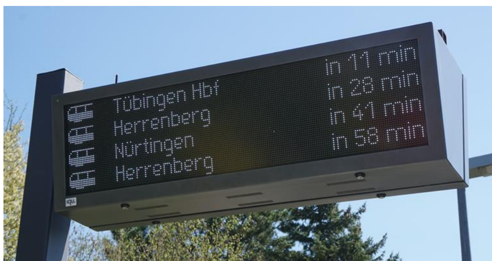
Beispiel: DFI-Anzeige Ammertalbahn (LED-Technik)
