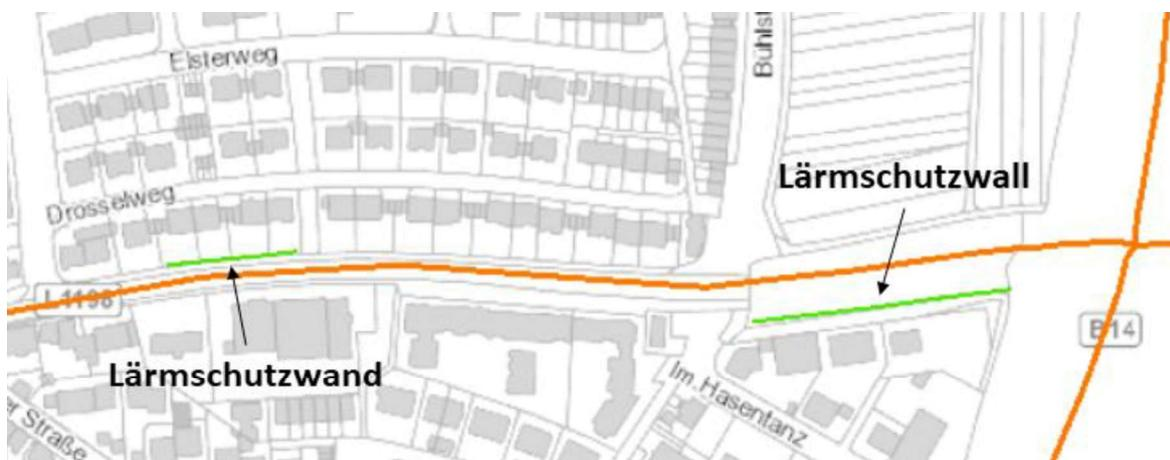
Abbildung 6: Bauliche Schallschutzmaßnahmen entlang der Landesstraße L 1198
