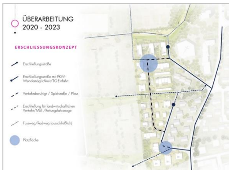
Abb. 3: Übergeordnetes Erschließungskonzept, H|G Architekten, Oktober 2023
